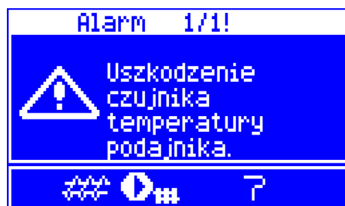
Rys. 31 Widok alarmu „uszkodzenie czujnika temperatury podajnika”.
