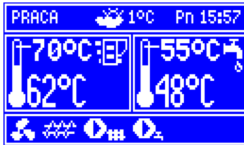
Rys. 5 Widok okna głównego regulatora podczas pracy. Wentylator pracuje w sposób ciągły co obrazuje Rys. 6. Podajnik paliwa załączany jest cyklicznie. Cykl składa się z czasu pracy podajnika oraz czasu przerwy w podawaniu.
