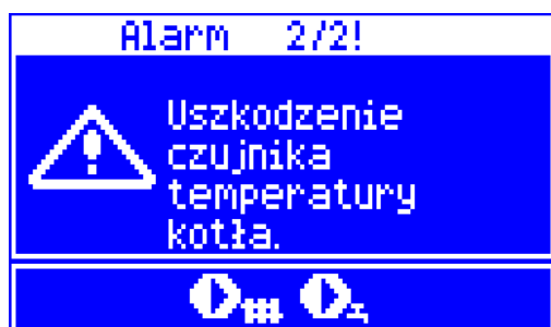
Rys. 30 Widok alarmu „uszkodzenie czujnika temperatury kotła”.
