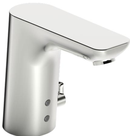
Bezdotykowa bateria umywalkowa z uchwytem regulującym temperaturę. Bateria jest wyposażona w filtry siatkowe, zawory zwrotne i elastyczne wężyki. Regulator przepływu (6 l/min) umożliwia małe zużycie wody (0,5 l podczas jednego cyklu użycia). Zasilanie elektryczne 12 V z oddzielnego zasilacza sieciowego (nr katalogowy Oras 199275).
