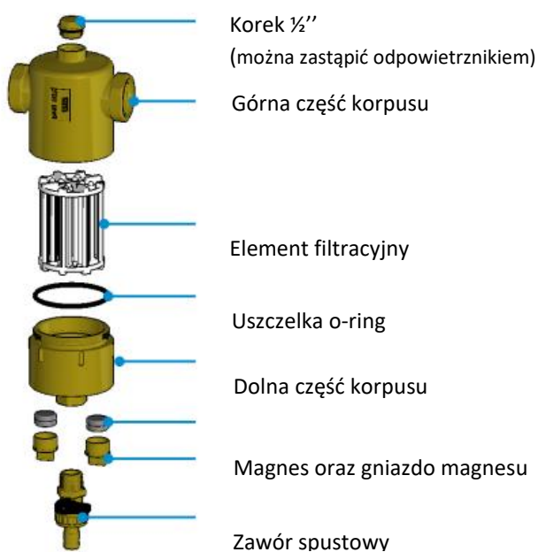
Rys. 3: Separator zanieczyszczeń FAR – budowa
