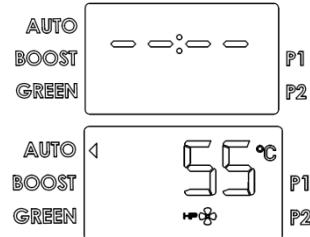
**Spegnimento:** per spegnere lo scaldacqua è sufficiente premere il tasto ON/OFF, rimane solo la scrittura “OFF” sul display. La protezione dalla corrosione continua ad essere assicurata e il prodotto provvederà automaticamente a non far scendere la temperatura dell’acqua nel serbatoio sotto i 5°C.
