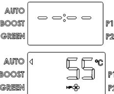
**Wyłączenie:** aby wyłączyć urządzenie należy nacisnąć przycisk ON/OFF, pozostaje jedynie widoczny komunikat "OFF" na wyświetlaczu. W tym trybie działa zabezpieczenie antykorozyjne zasobnika oraz zabezpieczenie przeciw zamrożeniowe, które nie pozwala na spadek temperatury poniżej 5°C.
