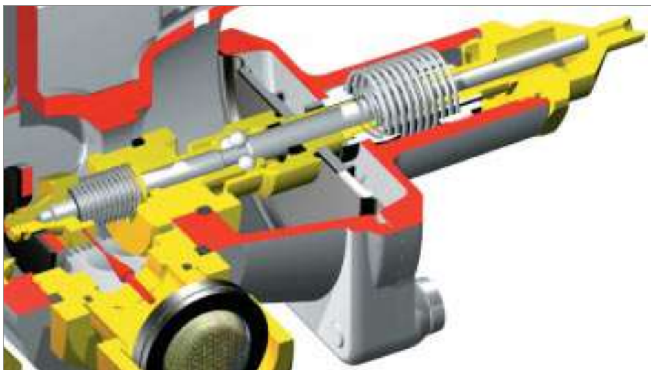
Szczegóły zaworu szybko zamykającego
