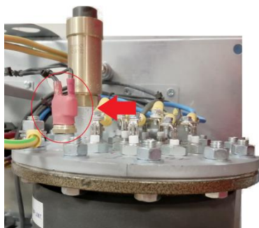
Rysunek 14 – lokalizacja wyłącznika termicznego.
