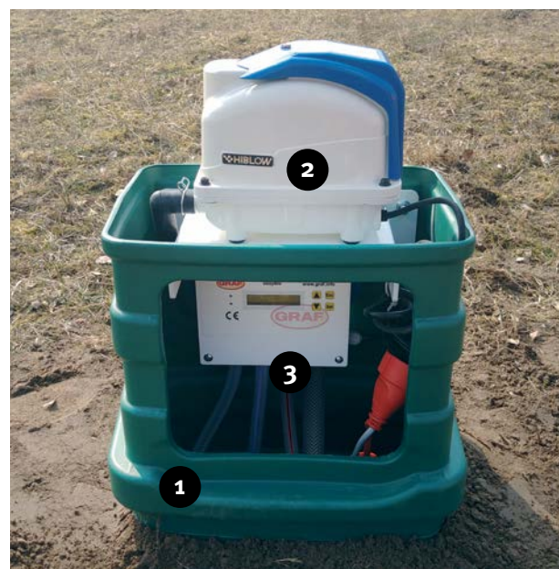
Rysunek 4. Elementy zespołu sterowania.
